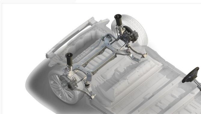
Enfin, la finesse de la batterie (110 mm) permet d'abaisser le centre de gravité du véhicule (-90 mm par rapport à une Mégane thermique), au profit de l'agilité. La répartition des masses s'équilibre grâce à l'intégration de la batterie sous tout le plancher.
