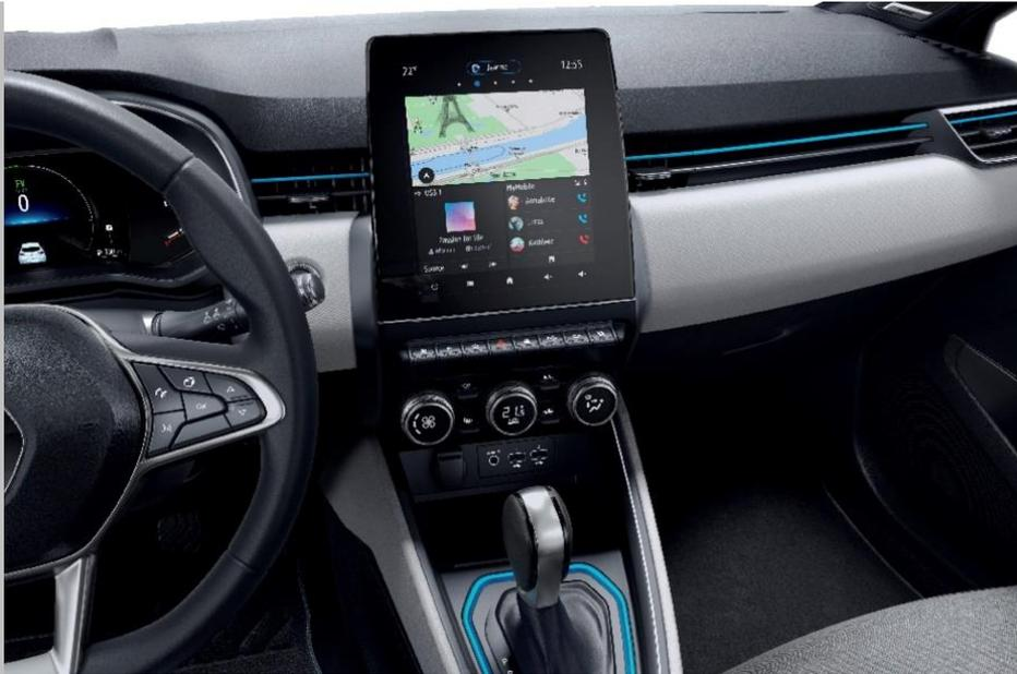
Le levier de vitesses spécifique dispose d'un badge « E-TECH ». Enfin, le bouton d'activation de la fonction Stop & Start sous l'écran multimédia est remplacé par un bouton « EV » spécifique, pour forcer le mode électrique – sous réserve d'une batterie suffisamment chargée.
