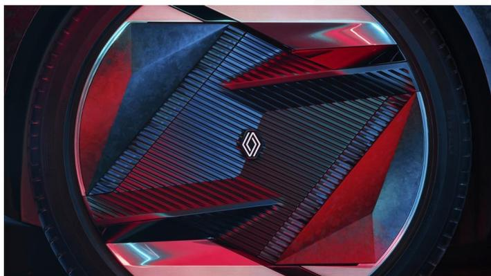
Chaussé de grandes roues de 21 pouces, les jantes de Renault Scenic Vision sont dotées de volets renforçant l'aérodynamisme et donc l'efficacité du véhicule. Lorsque la voiture est en mouvement (vitesse  $\geq 10\text{km/h}$ ), les volets se ferment pour un meilleur aérodynamisme. Dès que la voiture ralentit et que sa vitesse descend sous les  $10\text{km/h}$ , les volets s'ouvrent pour un meilleur refroidissement et une meilleure
