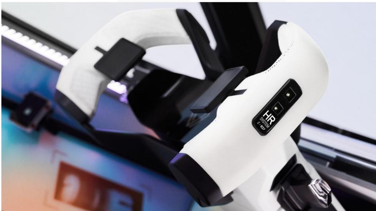
Pour une meilleure protection des usagers, de multiples capteurs physiologiques sont installés à bord de Renault Scenic Vision. Un capteur de fréquence cardiaque placé dans le volant et une caméra détectent en continu les signes de fatigue ou de faiblesse du conducteur. En cas de problème détecté, des signaux sont envoyés au conducteur et aux passagers.
