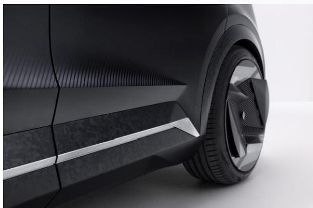
Les bas de portes, les élargisseurs de roues et les skis avant et arrière se caractérisent par leur aspect mat grâce à une conception utilisant des fibres de carbone recyclées. Ces détails renforcent le dynamisme et le caractère affirmé du concept-car.
