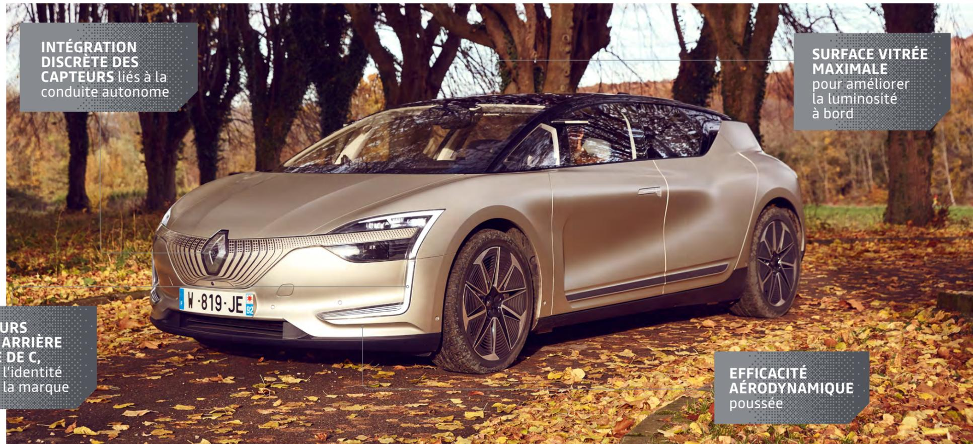
**INTÉGRATION DISCRÈTE DES CAPTEURS** liés à la conduite autonome
