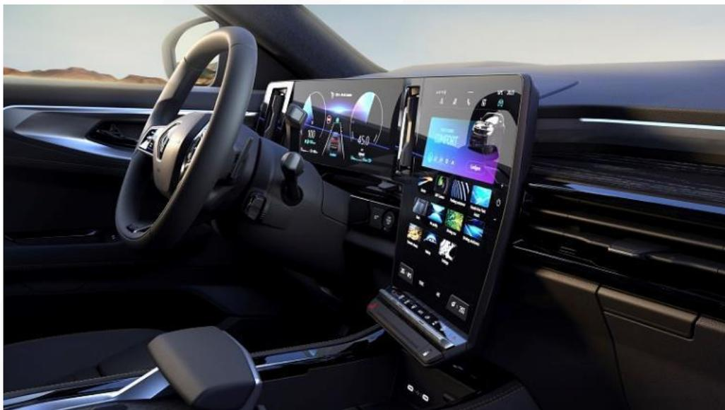
L'écran OpenR est doté d'une finition conforme aux standards des tablettes et smartphones haut de gamme. Il est recouvert d'un verre d'aluminosilicate de type « Gorilla Glass » : un verre trempé ultra-résistant aux rayures, aux chocs du quotidien et aux nettoyages répétés. En complément, il bénéficie de traitements spécifiques anti-traces et antireflets pour être aussi agréable à l'œil qu'au toucher.
