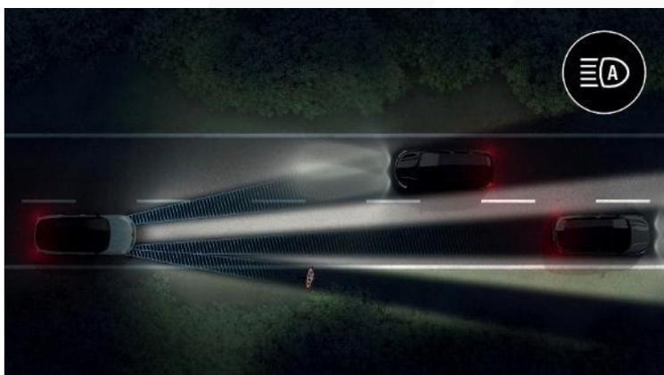
En version **Matrix LED Vision** (Matrix beam / ADB), le conducteur peut, en plus, rouler en feux de route de façon permanente pour un éclairage toujours maximal quel que soit le trafic environnant. Une performance rendue possible grâce à une technologie de diodes lumineuses anti-éblouissement capables d'adapter la distribution de la lumière pour garantir le confort et la sécurité du conducteur et des occupants des véhicules environnants.
